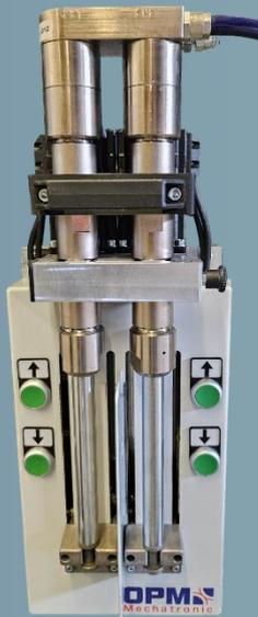
Die Doppelkolbendosiereinheiten von OPM ermöglichen eine exakte Dosierung von Flüssigfarben oder Additiven in den Extrusionsprozess mit einem Druck von bis zu 30 bar. Durch die Anpassung des Umschaltpunktes wird eine kontinuierliche, pulsationsfreie Dosierung erzielt. Speziell entwickelte Ventiltechnik sorgt für eine scherarme Förderung des Mediums durch die Pumpe.
